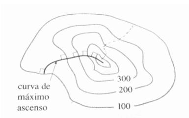
**Figura 2.** Trazo de una *Curva de Máximo Ascenso* usando solamente un par de escuadras y lápiz. Fuente: Stewart (2002), p. 935, Figura 12.
