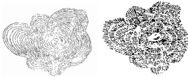
**Figura 3.** En la imagen derecha, diseño de una porción de planta topográfica utilizando la técnica del claroscuro. La imagen izquierda muestra las curvas de nivel sobre las que se logra la cobertura del diseño.
